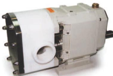
Pumpengehäuse/Pumpendeckel aus Thermoplast. Für größere Modelle oder hohe Betriebsdruckwerte sind Ausführungen erhältlich, bei denen alle mit dem Produkt in Berührung kommenden Teile aus Hastelloy und Monel sind, oder „gemischt“, z.B.: mobile Teile aus Titan, statische Teile aus Hastelloy.
