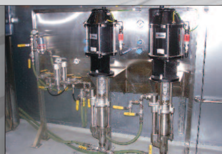
4-Kugel-Ventil- Kolbenpumpen, 4:1 übersetzt, eingesetzt zur Farbförderung.
