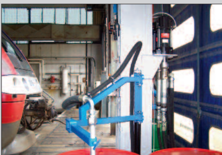
2-Kugel-Ventil- Kolbenpumpe 9:1 übersetzt, eingesetzt in einer Abschmieranlage für eine kundenspezifische Lösung.
