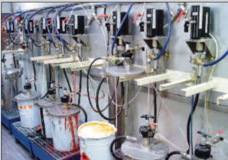
2-Kugel-Ventil- Kolbenpumpe, 4:1 übersetzt, eingesetzt in einer Lackieranlage.
