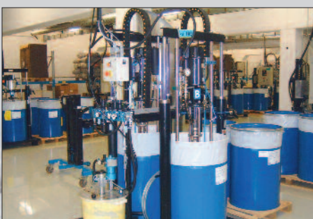
Extrusions Kolbenpumpe, 23:1 übersetzt, aufgebaut als Skid zur Silikonförderung.
