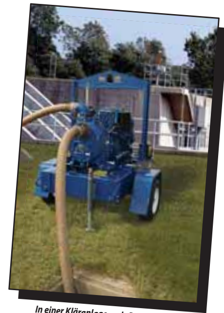
In einer Kläranlage... als Bypasspumpe während der Reparatur einer Pumpstation.
