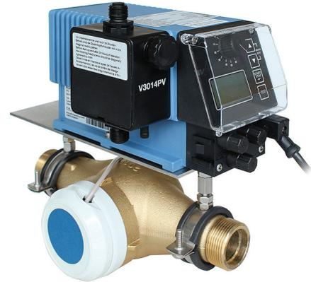
Die Kompaktdosiergeräte ELADOS® EMP sind für die Trinkwassernachbehandlung abgestimmte Dosiergeräte. Sie bestehen aus Kontaktwasserzähler inkl. Dosierventil und der Dosierpumpe. Über die mechanische Hubverstellung der Dosierpumpe kann die benötigte Konzentration gewählt werden.
