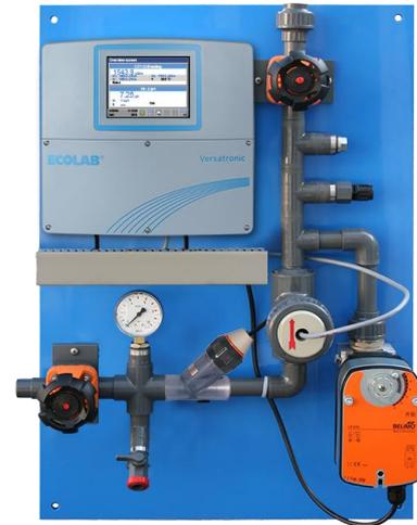
Das Versatronic Kühlwasser erlaubt eine vollautomatische Absalzsteuerung und eine timergesteuerte Bioziddosierung von bis zu drei Kühltürmen. Ist das Gerät nur für einen oder zwei Kühltürme ausgelegt so können pro Messkanal auch zwei Wochentimer für die Dosierung von zwei unterschiedlichen Bioziden eingestellt werden.
